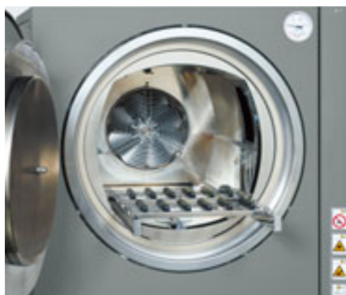
根据用户要求定做的滑动式试样架(使用例)
