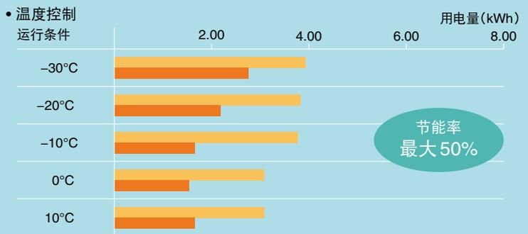
※无负荷、无试样时(水冷规格、标准运转模式)
