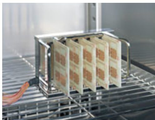
连接用夹具：梳形电路板、专用架(选购件)
