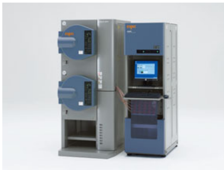
高速老化试验箱连接范例
